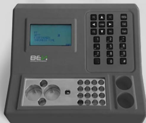
**SPA 1.0** è un coagulometro semiautomatico, un analizzatore ad alte prestazioni con rilevamento foto-ottico del coagulo.
